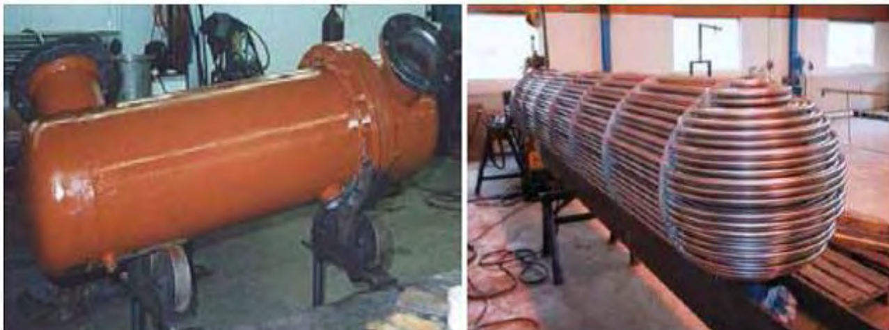
Hình 1.1. Thiết bị trao đổi nhiệt gồm có vỏ bọc bên ngoài (ảnh bên trái) và bên trong là bó các đường ống nhỏ (ảnh bên phải).
