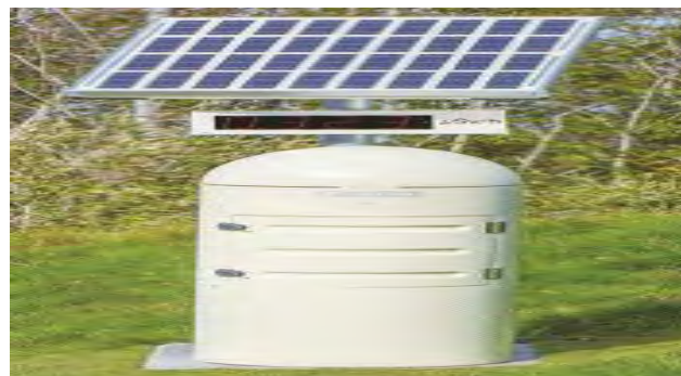
Hình 8. Thiết bị quan trắc phóng xạ trực tuyến NAH (Fuji, Nhật Bản).
