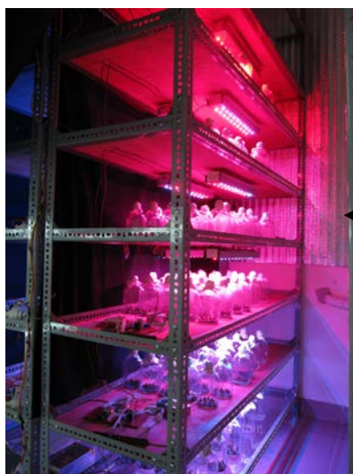
Hình II.11: 11 hệ LED được gắn trên kệ nuôi cây in vitro phục vụ cho thử nghiệm (đã tháo một phần vải đen để quan sát)
