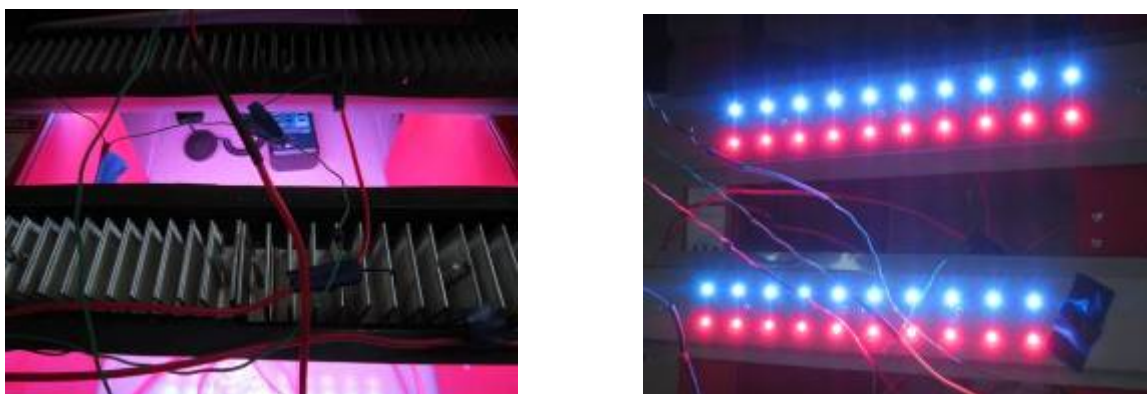
Hình II.4: Lắp một hệ đèn LED: a. mặt phía sau LED; b. mặt mắc LED
