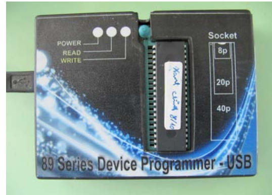
Hình II.9: Bộ kết nối nạp IC điều khiển AT89C51
