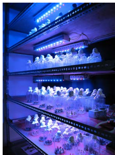
Hình II.11: 11 hệ LED được gắn trên kệ nuôi cây in vitro phục vụ cho thử nghiệm (đã tháo một phần vải đen để quan sát)
