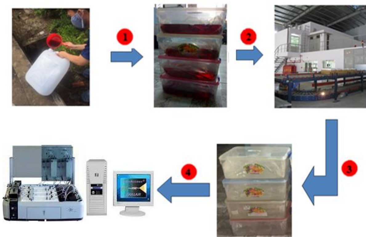
Hình 3.25. Quy trình xử lý chất màu trong nước thải nhà máy dệt nhuộm bằng phương pháp chiếu xạ chùm tia điện tử
