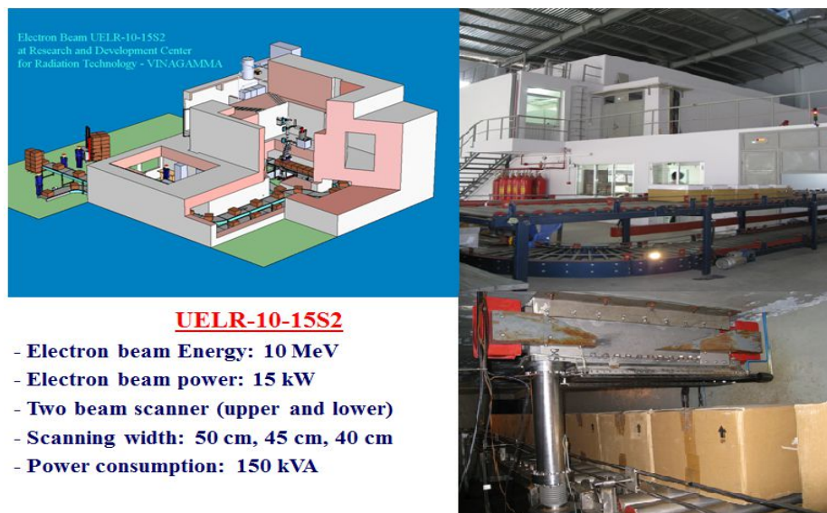
Hình 2.1. Máy gia tốc chùm tia điện tử UERL – 10 – 15S2
