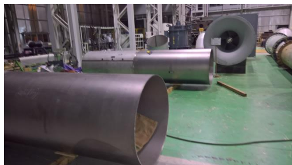
Hình ảnh điển hình ống áp lực của bơm được yêu cầu giám định chất lượng ( Vật liệu UNS 32750, giám định chất lượng hàn)
