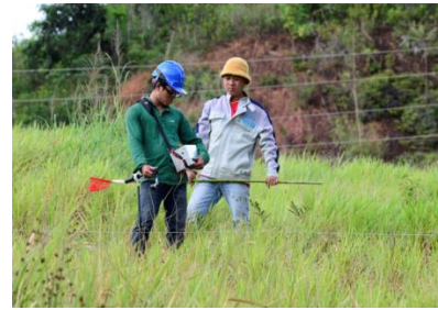
Đo từ trường cảm ứng tại đập
