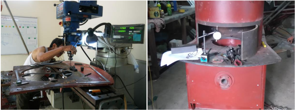
Hình 2: Gia công, chế tạo thiết bị tại Trung tâm Đánh giá không phá hủy: a) Gia công bàn máy thiết bị; b) Chế tạo buồng chiếu xạ
