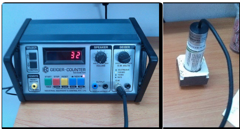
Hình 1. Hệ thiết bị ghi đo phóng xạ sử dụng ống đếm G-M trong PTN hạt nhân của trường ĐH Khoa Học Tự Nhiên, ĐHQG TpHCM.
