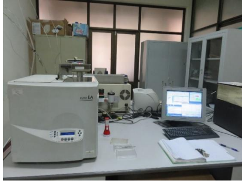
Hình 1. Khối phổ kế tỉ số đồng vị tại phòng thí nghiệm Thủy văn đồng vị Viện Khoa học và Kỹ thuật Hạt nhân.
