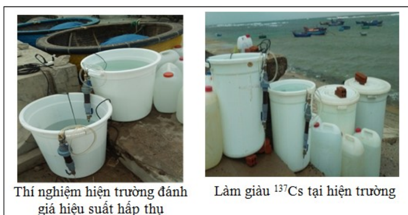
Hình 2. Làm giàu ^{137}\text{Cs} tại hiện trường bằng sợi acrylic tẩm \text{CuHCF}
