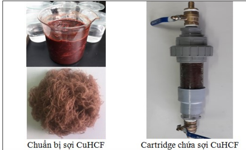
Hình 1. Sợi CuHCF và cartridge sử dụng trong nghiên cứu
