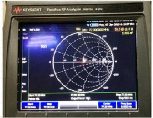
Hình 2. Trở kháng buồng cộng hưởng gia tốc phụ thuộc khoảng cách d đo bằng thiết bị N9912A.
