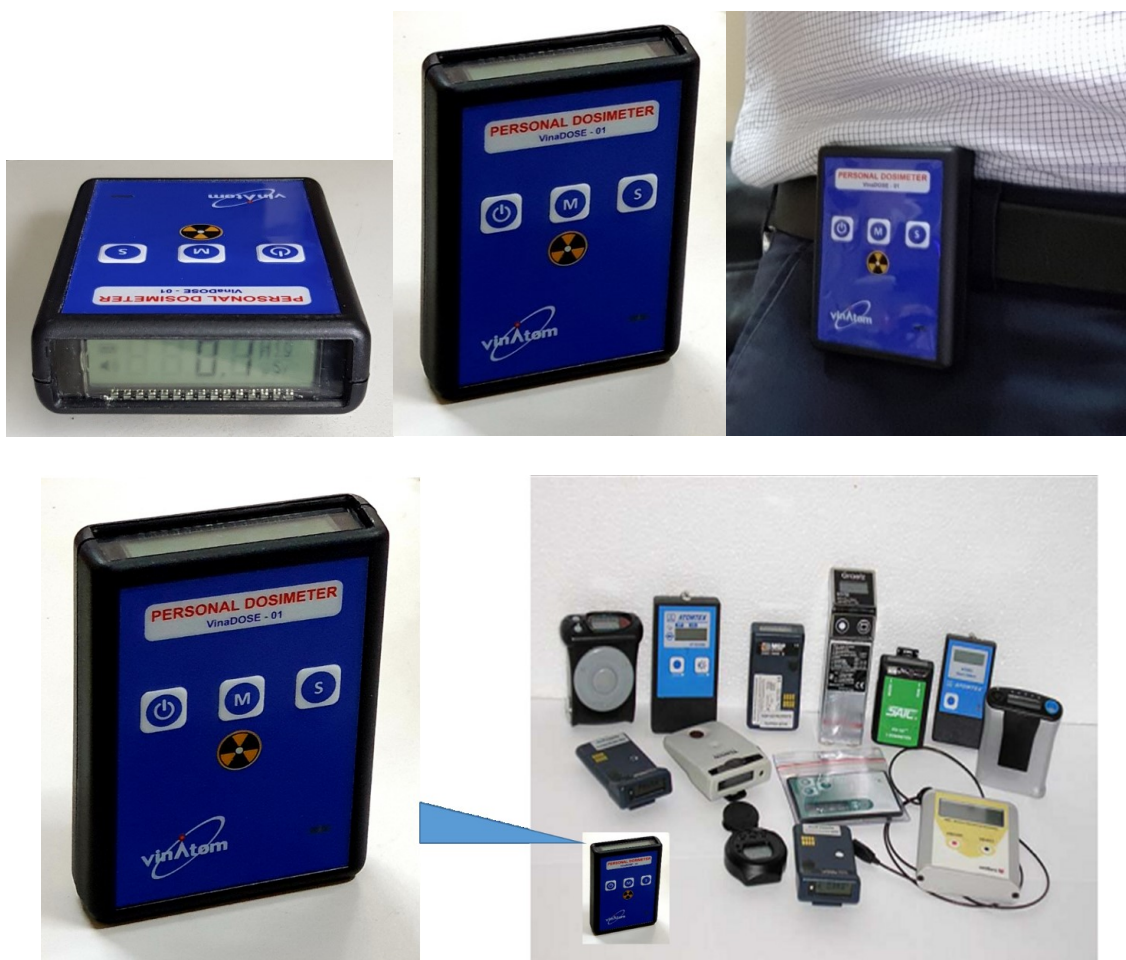
Hình 5. Liều kế cá nhân điện tử VinaDOSE-01 và so sánh với thiết bị của các hãng khác trên thế giới
