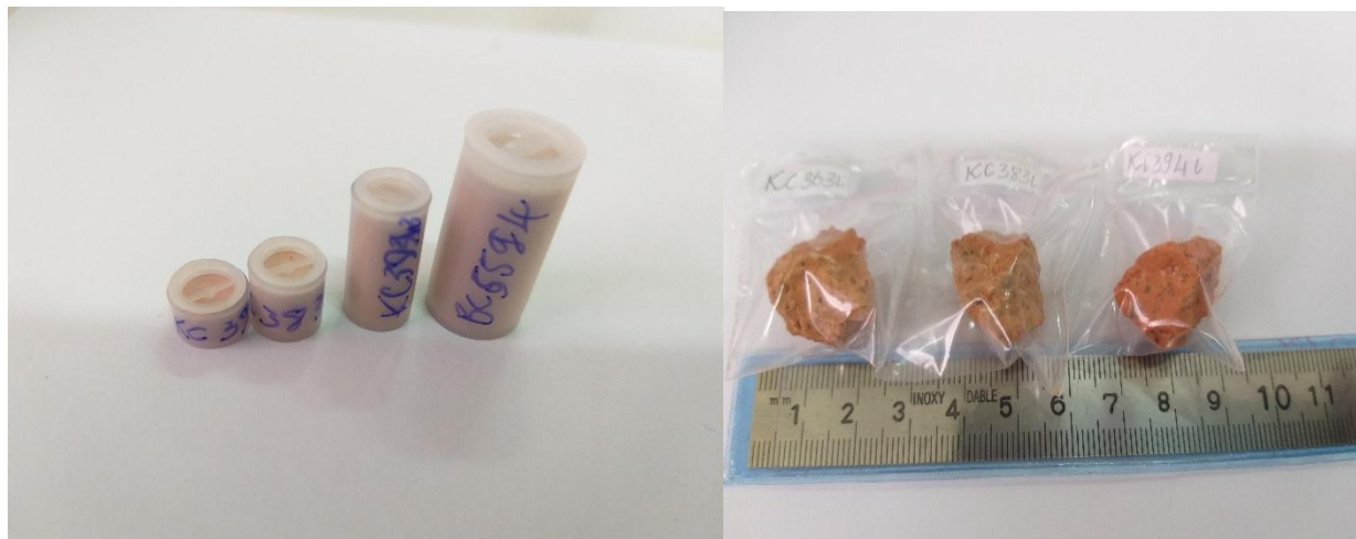
Hình 2.1. Hình dạng lọ đựng mẫu vial và mẫu hình học không xác định (LS).
