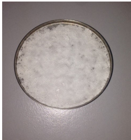
Hình 1. Dung dịch KCl đã được cô cạn trên đĩa thép không gỉ.
