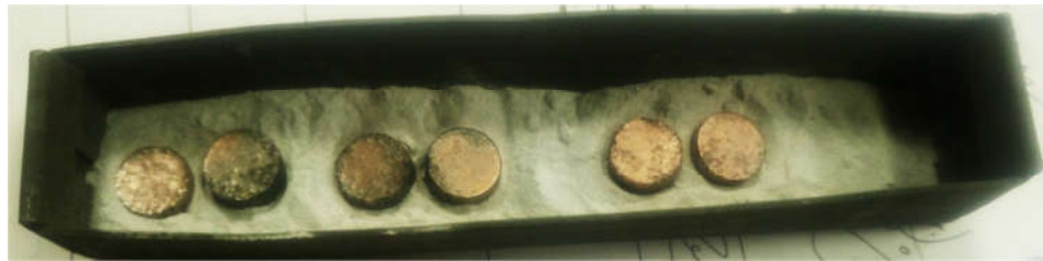
Hình 3: Mẫu thí nghiệm đã thiêu kết trong lò nung Hidro
