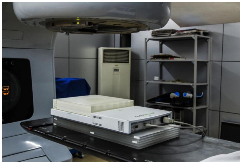
Hình 2. Thiết bị đo liều 2D MatriXX và phantom rắn SP33
