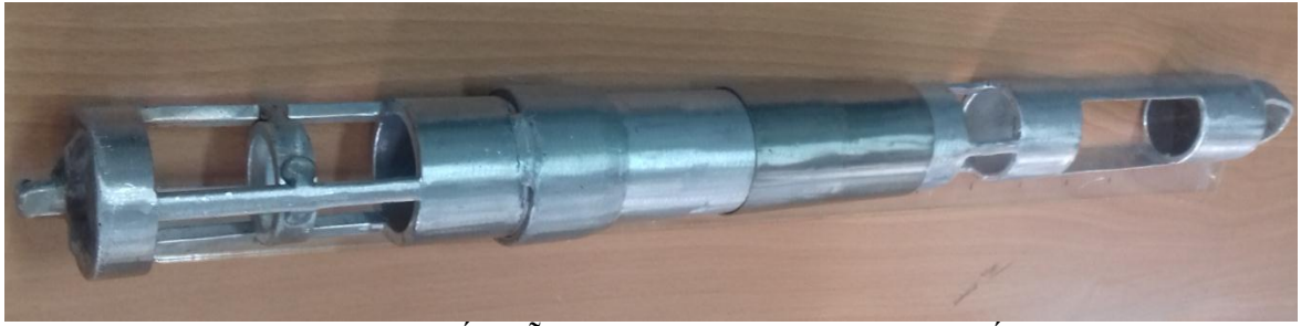
Hình 6. Kênh chiếu mẫu sử dụng phương pháp màn chắn
