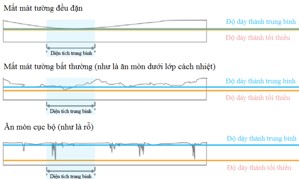
Hình 8: Mối tương quan giữa độ dày trung bình và độ dày tối thiểu trong các trường hợp hao hụt đều đặn, hao hụt bất thường và ăn mòn cục bộ
