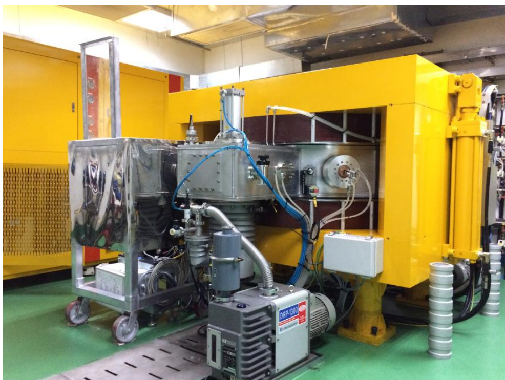
Hình 1: Hình ảnh máy gia tốc cyclotron KOTRON13
