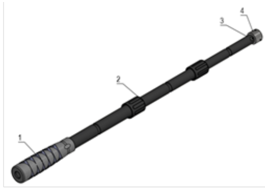
Hình 8: Thành phần cấu tạo của cán cầm máy đo SVG-2M
