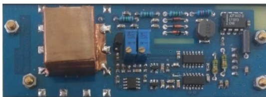
Hình 9: Khối ghi nhận Gamma và Neutron của thân máy chính
