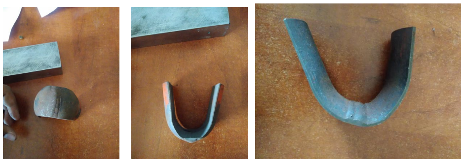
Hình 4. Mẫu thử uốn chân và mặt
