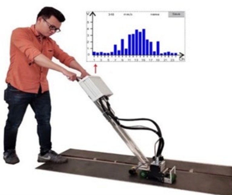
Hình 9 Thực nghiệm khảo sát thiết bị MFL trên tấm thép cacbon
