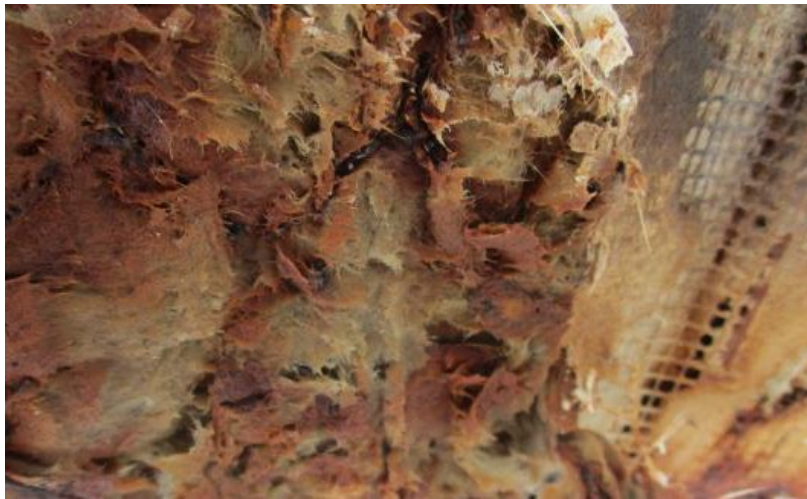
Hình 8. Vị trí có hơi ẩm được phát hiện đã được bóc lớp bọc để xác nhận
