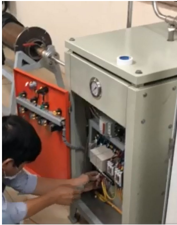
Hình 6a, 6b. Chế tạo, lắp đặt hệ thử nghiệm và các mẫu ống
