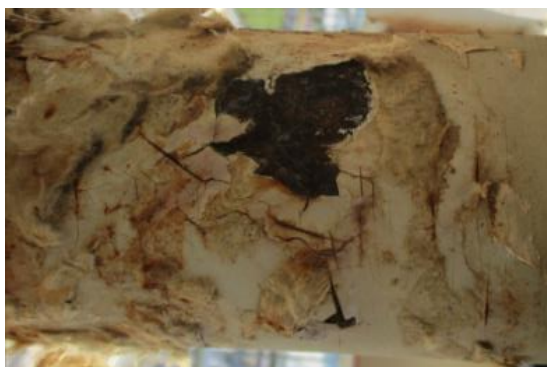
Hình 9a, 9b, 9c. Vị trí ăn mòn PL-50-C1B-2545 được kiểm tra bằng PEC, trước và sau khi xử lý
