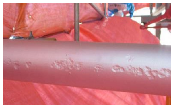
Hình 9a, 9b, 9c. Vị trí ăn mòn PL-50-C1B-2545 được kiểm tra bằng PEC, trước và sau khi xử lý
