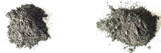
Hình 1: Bột graphite (trái) và graphite tróc nở (phải)
