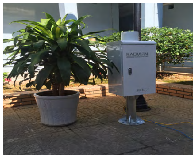
Hình 10: Một vài hình ảnh triển khai thực tế hệ thiết bị quan trắc cảnh báo phóng xạ.
