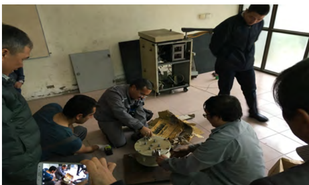
Các chuyên gia IAEA và các cán bộ NDE đo đạc khảo sát khối che chắn bằng Uranium nghèo.
