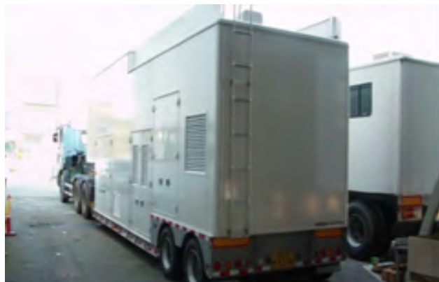
Hình 4: Xe lưu động xử lý nước thải bằng chùm điện tử
