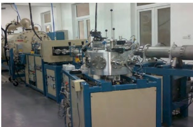
Hình 1. Máy gia tốc 5SDH-2 PELLETRON của HUS
