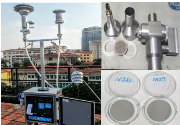
Hình 3. Thiết bị thu góp mẫu bụi khí Twin Dust, đầu thu góp mẫu PM1 và mẫu bụi khí PM trên phin lọc Polycarbonate Nuclepore
