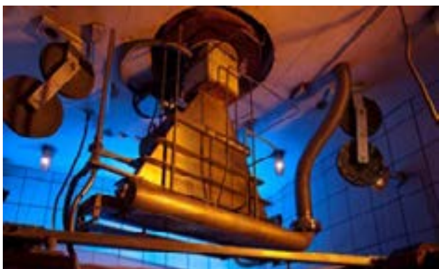
Hình 2. Máy gia tốc chiếu xạ được ứng dụng trong hệ thống công nghiệp
