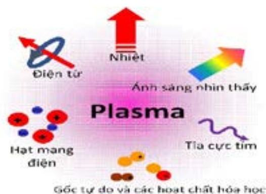
Hình 1. Thành phần vật chất cấu thành plasma
