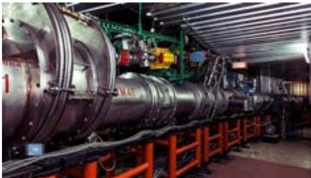
Hình 2. Máy gia tốc siêu dẫn hạt nhân và ion nặng Nuclotron tại PTN Veksler-Baldin
