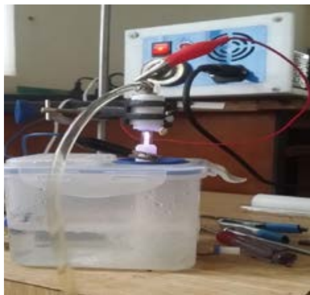
Hình 2: Thiết bị hoạt hóa nước bằng plasma lạnh gồm nguồn plasma và buồng gồm pha khí trên và pha lỏng dưới
