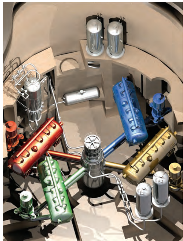
Sơ đồ bố trí các thiết bị xung quanh lò phản ứng VVER-1000
