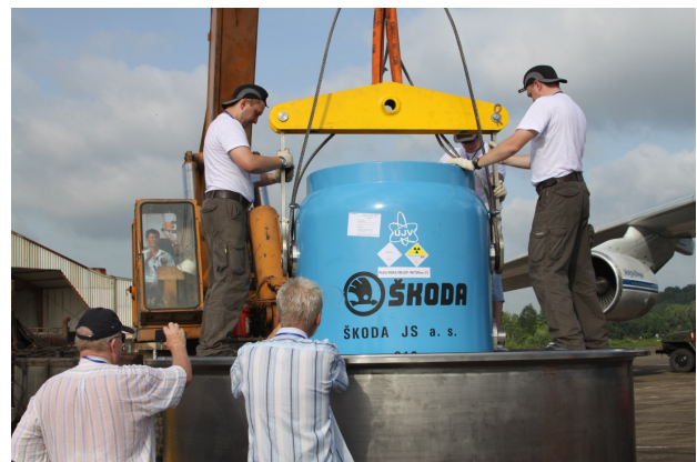
Đưa thùng chứa nhiên liệu hạt nhân Skoda cask vào thiết bị bảo vệ đặc biệt (TUK cask)
