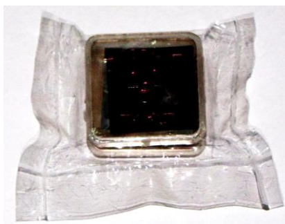
Hình 2: Bố trí màng PE đối với cấu hình hộp 3x3.
